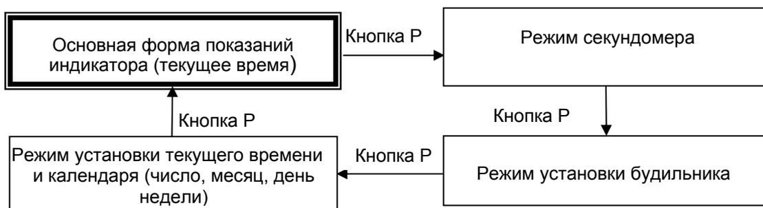
**Рисунок 3 - Схема переключения режимов работы ЖКИ**
