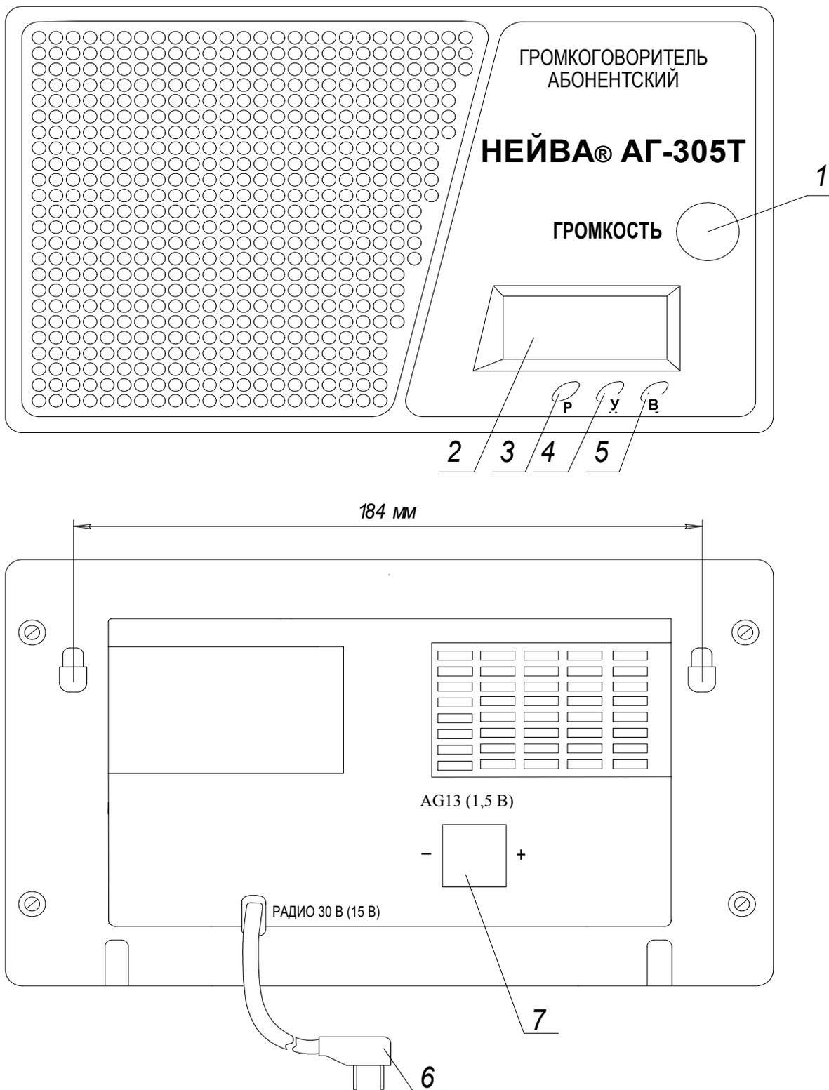
1 – регулятор громкости; 2 – индикатор таймера; 3 – кнопка Р (РЕЖИМ); 4 – кнопка У (УСТАНОВКА); 5 – кнопка В (ВЫБОР); 6 – вилка «РАДИО»; 7 – отсек питания индикатора «1,5 В».
